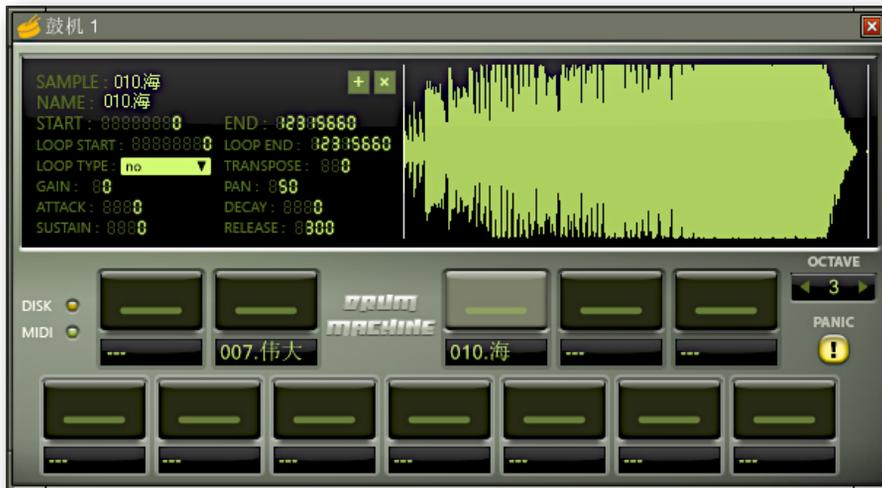
Drum Machine是一个简单的采样器,支持磁盘流缓冲,ADSR音量包络,采样循环,32复音等。选中一个打击垫可以显示当前采样的信息。点击+添加采样,x删除采样。用右键点击打击垫可以选中采样而不触发它。整个鼓机可以以一个八度为单位显示采样,按右边的Panic停止所有声音。注意:只支持WAV采样文件
