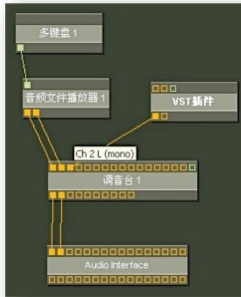
音频接口的Audio In 1可以是来自硬件调音台发送过来的信号，接在硬件音频接口的Line in 1上面；并将音频接口输出的1和2接到硬件调音台的两路输入：
