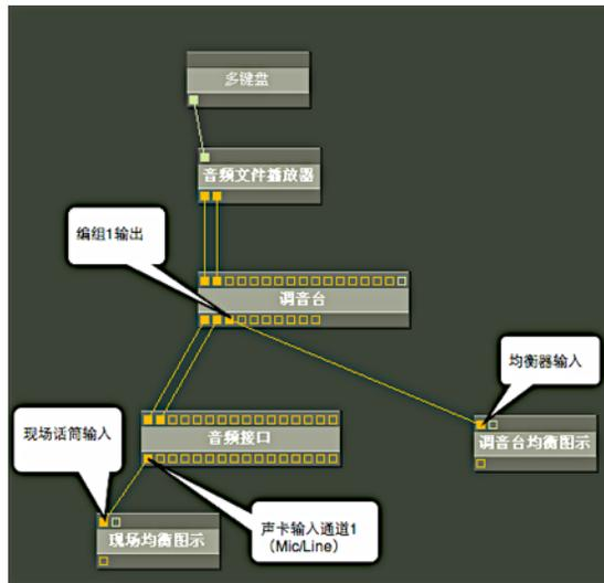
最上面的多键盘是1.2版本新增的设备，专门用于对软件的控制。音频文件播放器用于播放测试需要用的信号，它的输出连接到调音台的1/2两路输入。信号通过调音台的编组1输出给调音台均衡图示，用于观看调音台输出信号的频谱。
