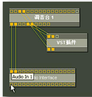
现在你可以通过软件调音台1通道上的Aux send 1发送信号给混响器，在插件里面效果参数，混响返回的量可以通过硬件调音台的推子来控制。
