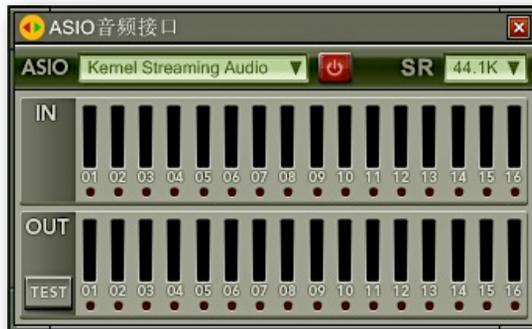
ASIO音频接口代表您的声卡,你可以通过这个设备将音频信号传送给声卡或从声卡取得输入的声音。选择一个ASIO设备,然后打开电源。注意:该设备的设备块的输入管脚对应声卡的输出,输出管脚对应这声卡的输入。
