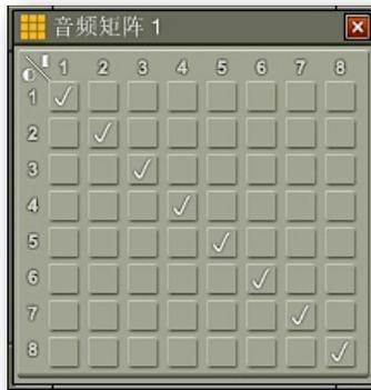
Audio Matrix是一个信号分配器,上边代表输入,左边代表输出。对应相交处打勾表示将此输入通路由到对应输出通道。
