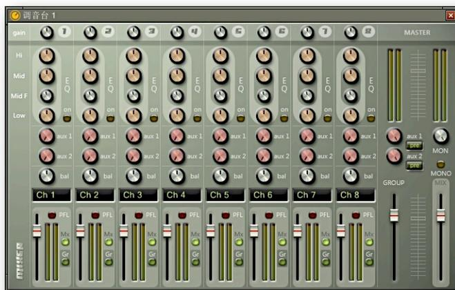
8 通道立体声调音台，用于音量，EQ的调整，路由声音输出通道。
